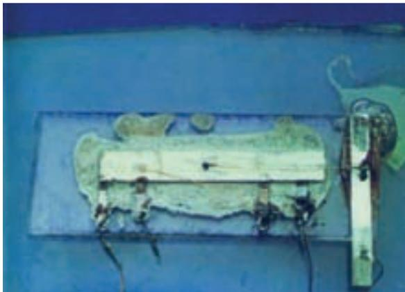
*Der Beginn einer Erfolgsstory im Jahr 1958: Die erste (etwa 1,5 cm breite) integrierte Schaltung mit einem Transistor und einigen anderen Komponenten stellte einen elektrischen Schwingkreis dar.*
