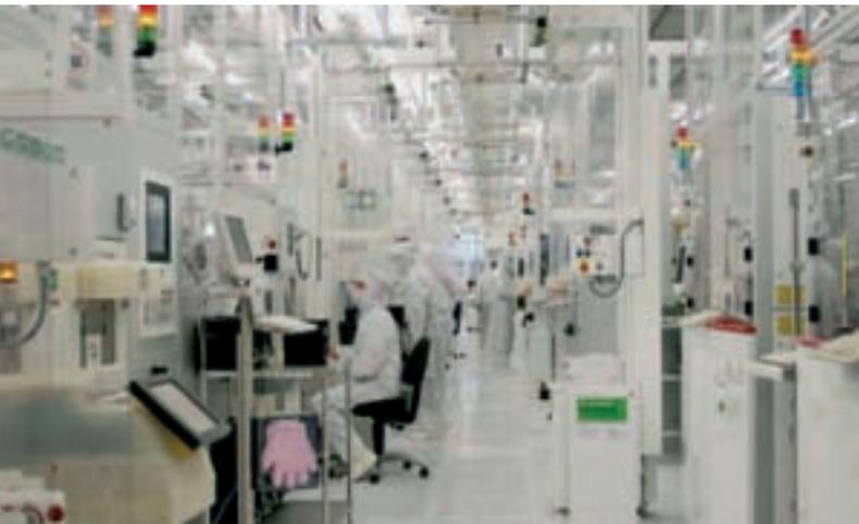
Reinraum in einer Chipfabrik. Ein Reinraum ist in verschiedene Zonen mit den Reinheitsklassen 10 bis 1000 unterteilt. Ein für die Chipproduktion notwendiger Klasse 10 Reinraum hat 20.000 x weniger Partikel vergleichbarer Größe als ein normaler Wohnraum.
