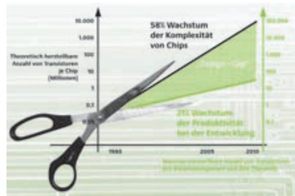
Die Entwurfsflücke (engl. „Design-Gap“) öffnet sich scherenartig: Die Komplexität (Zahl der Transistoren) der herstellbaren Chips wächst mit den Jahren viel schneller als dies von den Chipentwicklern umgesetzt werden kann. Ohne eine (Teil-)Kompensation durch bessere EDA-Software werden hochkomplexe Chips zwar gefertigt, aber nicht entworfen werden können.
