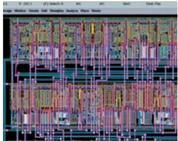
*EDA heute: Das Layout von Schaltungen mit Millionen von Transistoren läßt sich nicht nur am Computer in jeder Vergrößerung darstellen, sondern es kann auch automatisch erzeugt und optimiert werden.*
