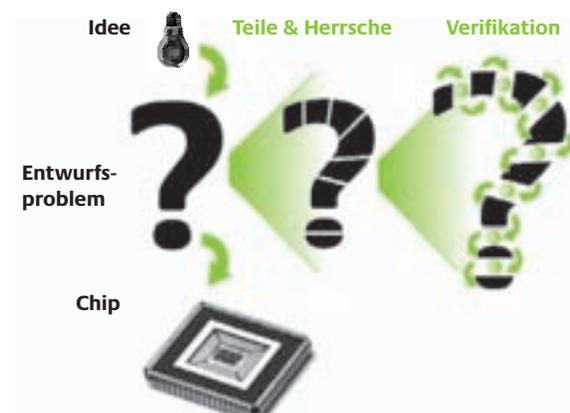
Das Entwurfsproblem – nur zu lösen durch das Prinzip: Teile und herrsche. Die Komplexität des Entwurfsproblems (wie man von der Idee zum Chip kommt) ist so groß, dass man in Teilschritten vorgeht, die immer wieder gegeneinander zu überprüfen sind (Verifikation)
